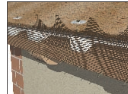
Particolare posa della griglia per la protezione dei canali di ventilazione e della griglia parapassero per il manto di copertura.
