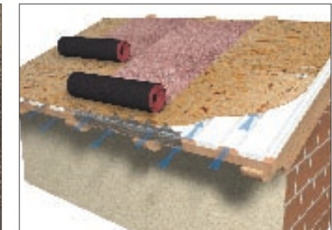
Posa della membrana bituminosa ardesiata per l'impermeabilizzazione dell'estradosso.
