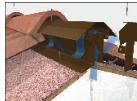
Particolare della posa del colmo ventilato TURBOAIRY e accessori collegati.
